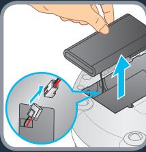
**NL** Maak het batterijdeksel los met behulp van een schroevendraaier. Ontkoppel de batterij en haal deze uit de robot.
