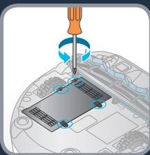
**IT** Svitare il coperchio della batteria con un cacciavite. Collegare la batteria e rimuoverla dal robot.
