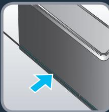
**PT** Ligue o adaptador na entrada da alimentação na parte lateral da base. Guarde o fio em excesso na parte traseira da base, no respetivo espaço. Use apenas o carregador fornecido com o robô. Não use carregadores universais.
