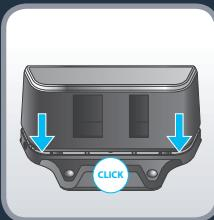
**PT** Una as duas partes da estação de acoplamento.
