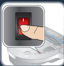
**IT** Capovolgere il robot e portare l'interruttore in posizione di spegnimento (O).
