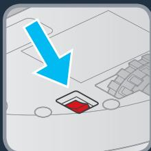
**PT** Vire o robô e rode o interruptor da energia para a posição de ligado (I). Verá as luzes LED a piscar no painel do robô durante alguns segundos.
