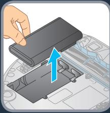
**SK** Pomocou skrutkovača odskrutkujte kryty priestoru pre batérie. Batériu odpojte a vyberte z robota.
