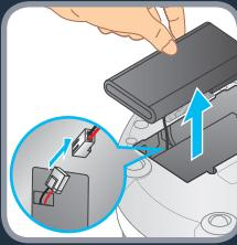
**ES** Con un destornillador, desatornille las tapas del compartimento de la batería. Desconecte la batería y extraiga la batería del robot.
