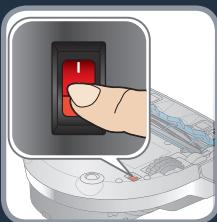
**PT** Vire o robô e rode o interruptor da energia para a posição de desligado (O).
