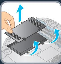
**CS** Šroubovákom odšroubujte víko prostoru pro baterie. Odpojte baterii a vyjměte baterii z robota.
