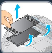
**FR** À l'aide d'un tournevis, dévissez le couvercle du compartiment des piles. Déconnectez la batterie et retirez la batterie du robot.
