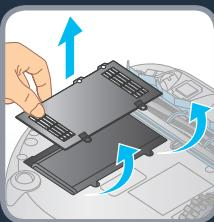
**DE** Schrauben Sie mit einem Schraubendreher die Akkufachabdeckungen auf. Trennen Sie den Akku und entfernen Sie den Akku aus dem Roboter.
