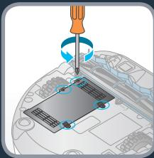
**PT** Com uma chave de fendas, abra a tampa do compartimento da bateria. Desligue a bateria e retire-a do robô.
